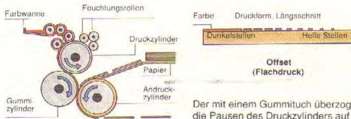
Der mit einem Gummituch überzogene Zylinder nimmt die Pausen des Druckzylinders auf und überträgt das Papier
